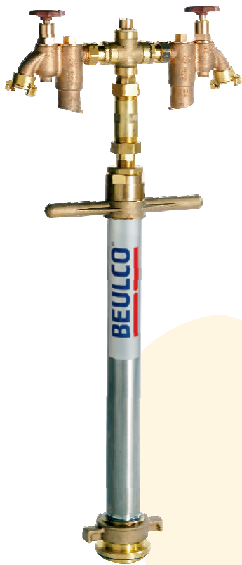
Trinkwasserstandrohr mit 2 x Systemtrenner BA DN 20 Geka-Kupplung
