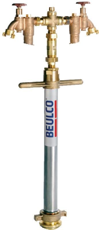
Trinkwasserstandrohrer mit 2 x Systemtrenner BA DN 20 Geka-Kupplung
